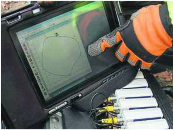
Auf dem Computer entsteht mit Hilfe der Schallsensoren ein Bild vom Zustand des Baumes.
