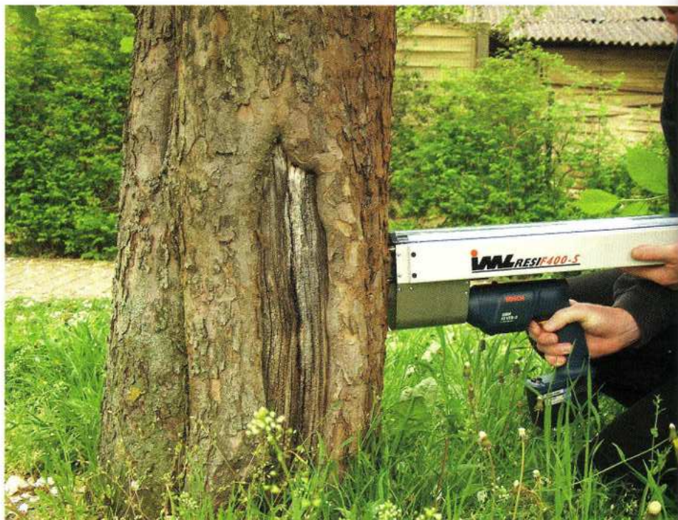
Abb. 5: Mit dem Resistographen wird die Restwandstärke eines Baumes gemessen, eines wichtigen Kriteriums für die statische Stärke eines Baumes.
